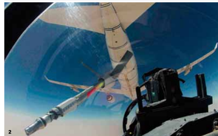
1 프로브&드러그 방식은 공중급유기가 길게 늘어뜨린 호스 끝의 드러그에 전투기의 수유관인 프로브를 꽂아 급유한다. 드러그에 프로브를 꽂는 것은 전투기 조종사의 역할. 2 일명 플라잉 불 방식은 단단한 막대 형태의 불을 전투기의 수유 장치에 꽂아 급유한다. 이 과정은 공중급유기의 불 담당자가 처리한다.
